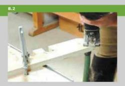
На другом конце просверливается отверстие 8 мм под крепёжный болт, который в дальнейшем будет служить осью вращения. При помощи лобзика производится скругление обоих концов в форме полукруга и выемки для фиксации вырезаются до отверстия.
