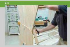
9. Двумя крепёжными болтами (М8 х 60) обе стороны соединяются с верхней частью пляжного кресла. В данном случае также между деревянными деталями и под гайку устанавливается подкладная шайба. Проверьте, входят ли выемки для фиксации надлежащим образом в стержень и при необходимости обработайте их дополнительно.
