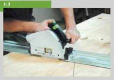
При помощи шнура и карандаша нанесите разметку верхнего изгиба. Для меньших радиусов используется циркуль. Распилите щит лобзиком по линии верхнего изгиба. Для пропилов по прямой используйте дисковую пилу и шину-направляющую. Разметьте вторую боковую деталь посредством переноса контура первой (поз. 19) на лист фанеры.
