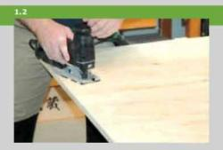
Распиловку больших щитов можно производить дисковой пилой либо на козлах, либо на грунте, предварительно подложив бруски. По возможности все прямые кромки следует отпиливать дисковой пилой, используя шину-направляющую. Распиловка по линии изгибов и скруглений производится лобзиком при помощи пилки для криволинейной обработки.
