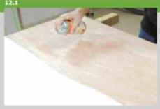
12. Чтобы своими силами изготовить простую подушку, необходимо отпилить по размеру лист фанеры толщиной 6 мм. Затем соответствующим распыляемым клеем приклейте пенопласт нужной толщины. Необходимо выбрать материал, который легко поддаётся чистке и подходит для использования на открытом воздухе.
