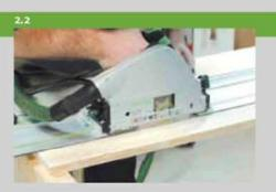
Отметьте оба выреза под опоры для ног на передней стороне (поз. 2). Используйте для изготовления вырезов лобзик или, при наличии возможности, погружную пилу с шиной-направляющей. Скругления в углах также вырезаются лобзиком.
