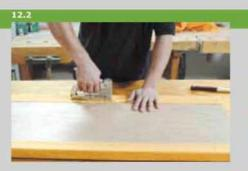
Раскрой материала производится таким образом, чтобы после его загибания на подушку и фанеру с обратной стороны осталась полоса шириной ок. 100 мм. С помощью скобозабивателя материал крепится к фанере. Сначала на обеих продольных сторонах, а затем, как при упаковке подарка, на поперечных сторонах.
