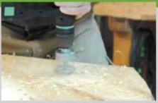
2. Отметьте на верхних боковых деталях (поз. 19) и на внешних сторонах (поз. 18) положение отверстий. Просверлите отдельные отверстия указанного диаметра. Обратите внимание на то, что все отверстия диаметром 30 мм сверлятся на глубину 15 мм. На всех изогнутых деталях лобзиком вырежьте скругления и выемки.
