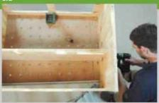
Просверлите соединительные отверстия между внутренней стороной и длинным средним элементом, затем разместите средний элемент по линии и прикрутите его. Отметьте положение короткого среднего элемента и также прикрутите его через переднюю сторону и длинный средний элемент.
