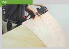
Работать будет удобнее, если помощник будет при этом прижимать крышу к сторонам. Отметьте положение поперечин и на них также закрепите крышу шурупами. Снимите заусенцы с кромок и углов крыши ручным шлифовальным бруском.
