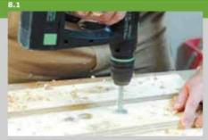
8. Отметьте на сторонах (поз. 21) положения фиксации спинки. Сначала на верхнем конце выемок для фиксации просверливается отверстие диаметром 30 мм. Во избежание образования сколов с обратной стороны подложите обрезок. На одном конце каждой детали просверлите по отверстию диаметром 30 мм на глубину 15 мм, в которые будет вставляться стержневая ручка.
