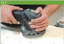
11. Перед обработкой поверхности пляжное кресло необходимо разобрать на нижнюю часть, верхнюю часть, складной механизм, посадочную поверхность, крышку встроенного отделения, опоры для ног и подлокотники. Фанера на видных местах шлифуется эксцентриковой шлифмашиной и абразивной бумагой с зерном Р180.
