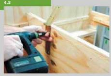
Центр вращения петель должен находиться точно на верхней кромке среднего элемента. Сначала закрепите короткие петли (поз. 34) на опорной доске и затем крышку (поз. 5) на петлях. Затем сверху прикрутите опорную доску через средний элемент к опорной рейке.
