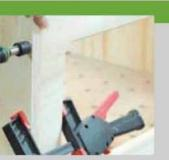
3. Закрепите вместе внутренние стороны (поз. 1), а также переднюю и заднюю стороны (поз. 2) и просверлите отверстия (D= 4,5) под шурупы Spax (4 x 50). Соедините между собой четыре детали. Отметьте на обеих внутренних сторонах с помощью короткого среднего элемента (поз. 4) расстояние между фасадом и длинным средним элементом (поз. 3).
