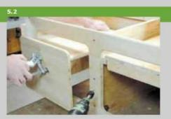
Затем отметьте верхний край опоры на фасаде или соедините их при помощи струбцины. Выньте опору и соедините шурупами крепёжную рейку (поз. 11) и фасад.
