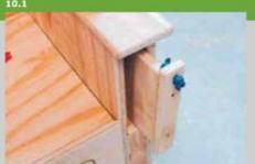
10. Каждый съёмный столик состоит из доски (поз. 24), на которой сзади с одной стороны имеется паз глубиной 50 мм и шириной 20 мм (толщина материала). В накладке (поз. 25) сверху просверливается отверстие 8 мм для протягивания в дальнейшем шнура. На накладке скруглите все кромки.
