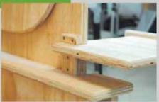
Затем вставьте столик, прижав к кромке, и сверху прикрутите второй брусок. Во время завинчивания прижимайте столик вниз. Столик можно вставить с выступом как наружу, так и внутрь. Для хранения он просто убирается в подлокотник.
