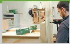
6. Внешние стороны (поз. 18) фиксируются на основной части. Просверлите отверстия с резьбой во внешних сторонах и прикрутите одну сторону (Spax 4 x 50) к основной части. Прежде чем закрепить вторую сторону, необходимо вставить круглый стержень для фиксации (поз. 30) в предварительно просверленные отверстия. Круглый стержень фиксируется двумя шурупами
