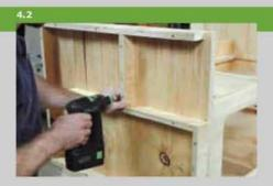
Отметьте на опорной доске для крышки (поз. 6), с обеих сторон, выемки под четыре петли и вырежьте их лобзиком. Прежде чем закрепить доску на корпусе, установите петли (поз. 33), к которым крепится спинка (поз. 22) (Spax 4,5 x 20).
