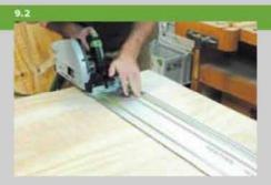
Установите верхнюю часть пляжного кресла в вертикальное фиксированное положение. Спинка (поз. 22) с обеих сторон вырезается, как показано на чертеже. Затем скругляются кромки. Далее поставьте спинку в кресле на средний элемент и выровняйте её по центру.
