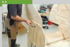
на внешней стороне. Между сторонами и под гайки устанавливается подкладная шайба. Затем в предварительно просверленные отверстия вставьте круглый стержень, к которому будет прилегать спинка (поз. 29), и соедините шурупами вторую верхнюю сторону с внешней стороной.
