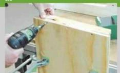
5. Для крепления опоры для ног (поз. 9) к выдвижной части на передней стороне снизу привинчивается рейка (поз. 11). Задвиньте опоры для ног и поставьте перед ними в вырез фасад. Фасад выравнивается таким образом, чтобы он по периметру имел одинаковый зазор.
