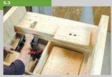
После того как фасад закреплён, выдвижная часть снова ставится на направляющие и к заднему краю крепится стопорная рейка (поз. 10). Сборка второй выдвижной части производится аналогичным образом. Под боковыми элементами выровняйте обе опорные рейки (поз. 17) и прикрутите их.
