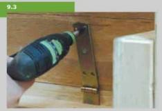
Петли при помощи шурупов Spax (4,5 x 20) крепятся к спинке. Проверьте ещё раз, уже с установленной спинкой, действие механизма наклона.
